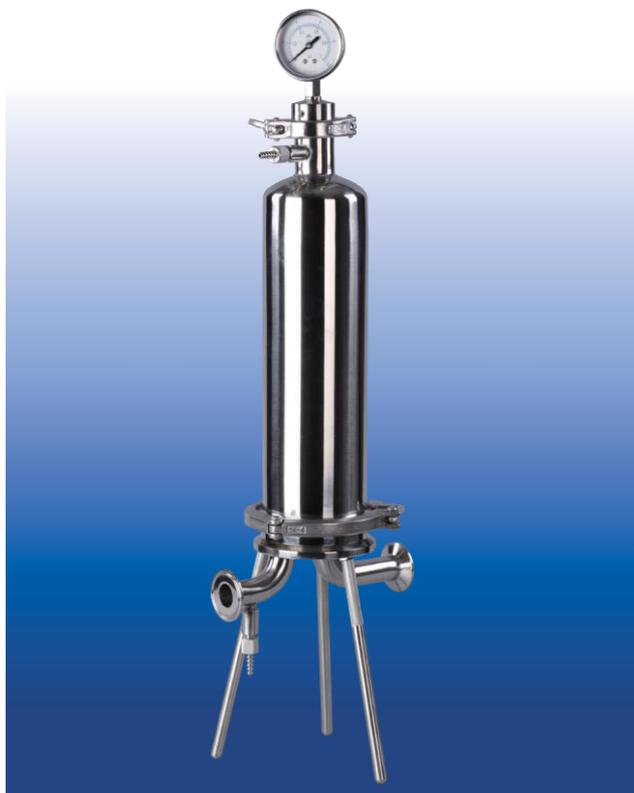
サニタリー仕様のシングルラウンド液体フィルターハウジングは、衛生的な構造になるよう設計されており、滑らかな溶接とTC型のサニタリー接続が特徴です。分解や清掃が簡単で、低～中圧の環境での低流量フィルタリングに適しています。製薬、バイオテクノロジー、食品・飲料業界などで広く使用されています。
