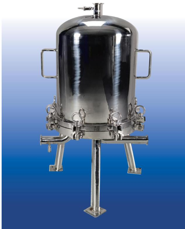
フィルターモジュール用サニタリーハウジングは、新しいタイプの深層ろ過フィルターハウジングです。衛生的な設計を重視し、滑らかで隙間のない溶接とTC型サニタリー接続を採用。清掃や分解が簡単に行えます。また、容器の下部に配置された直線的な流路設計により、液体の乱流を抑え、スムーズな流れを実現します。対応カートリッジは8インチ、12インチ、16インチの3種類。最大4モジュールまで組み合わせることで、高流量のニーズにも対応可能です。
